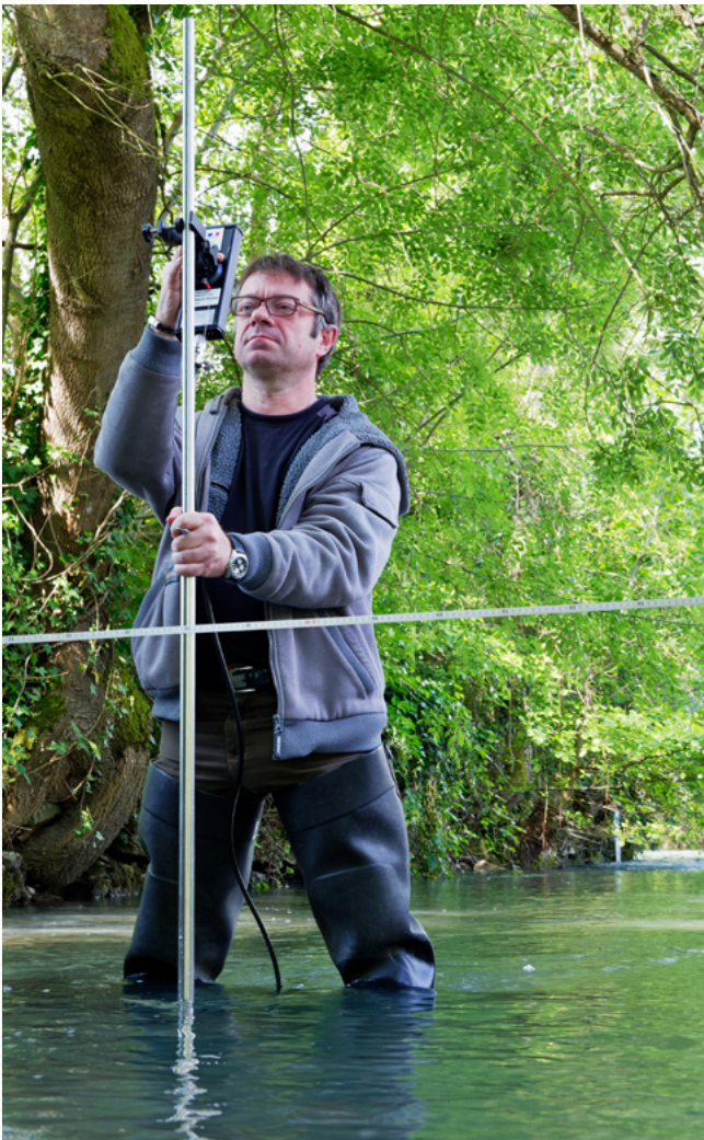
Jaugeage à la station d’hydrométrie sur le Son-Sonnette, affluent de la Charente © Thierry Degen / Terra
